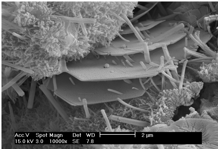
Hydratace Ultracoloru Plus, který obsahuje speciální pojivo na bázi hydraulických pojiv. Všimněte si absence tyčinkových krystalů hydroxidu vápenatého, který způsobuje výkvěty
